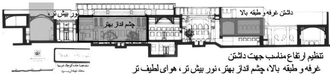
شکل شماره ۱۱- کیفیت فضا منطبق بر عبادت و آسایش اقلیمی، ماخذ: (نگارنده)
