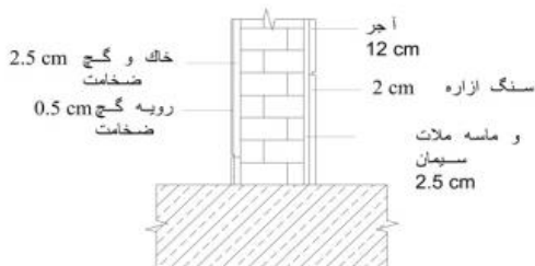
تصویر ۲- جزئیات اجرای دیوارهای مدرسه (http://www.liveroof.com/detail-drawings)
