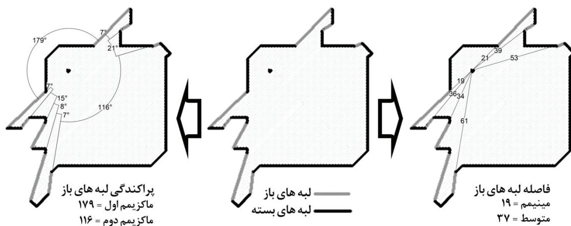
تصویر ۴ – فاصله و پراکندگی لبه های باز. چپ: لبه های باز ایزوویست. وسط: متغیرهای فاصله لبه باز نشان دهنده فاصله نزدیک ترین نقطه لبه باز به بیننده در مرکز ایزوویست هستند. راست: متغیرهای پراکندگی لبه باز کمی کننده نحوه پراکنده شدن لبه های باز در محدوده دید را هستند.
