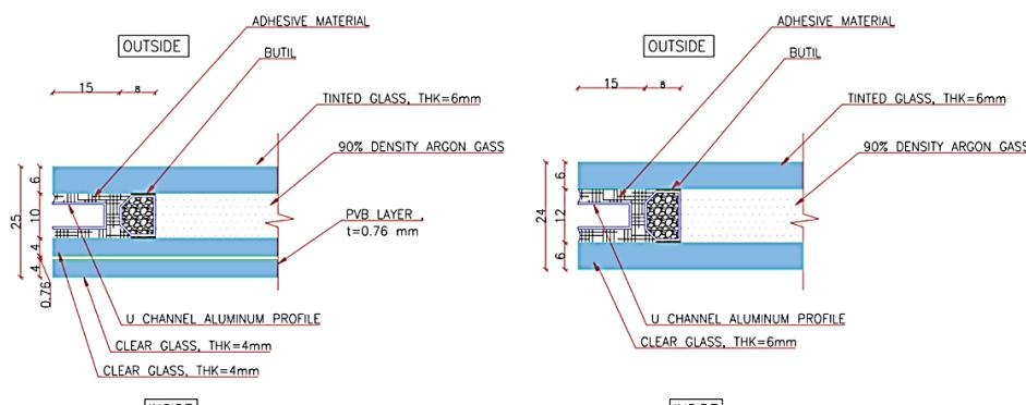
تصویر ۳- ساختار شیشه مدل پایه (راست)، ساختار شیشه پیشنهادی (چپ)
