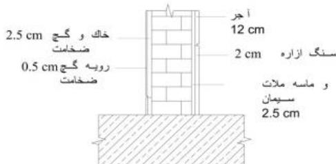
تصویر ۲- جزییات اجرای دیوارهای مدرسه (<http://www.liveroof.com/detail-drawings>)
