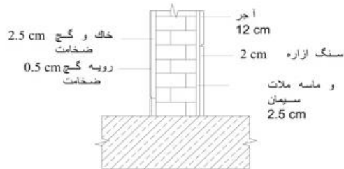
تصویر ۲- جزئیات اجرای دیوارهای مدرسه ( http://www.liveroof.com/detail-drawings )
