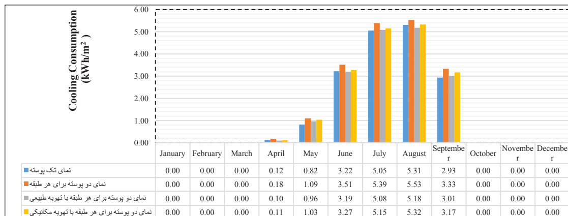
تصویر ۱۰- مصرف انرژی سرمایشی در فصل گرم برای نمای تک پوسته و دوپوسته برای هر طبقه در صورت تهویه هوای بین دوپوسته
