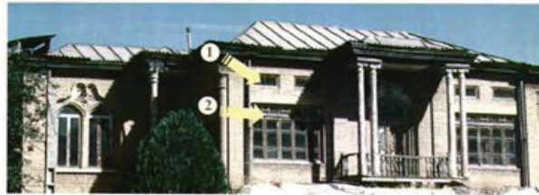
نمای جنوبی خانه سیدین - ساخت: مؤلف ۱- روزن های بالای پنجره ها جهت تهویه هوا و ورود نور به داخل فضاها ۲- پنجره های روبه حیاط - ۵ لنگه با کتیبه های شیشه ای در بالای آنها
