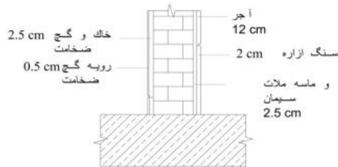
تصویر ۲- جزئیات اجرای دیوارهای مدرسه (http://www.liveroof.com/detail-drawings)
