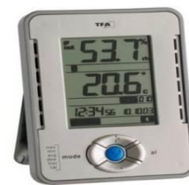
تصویر ۲- دستگاه data logger TA 120 (www.supertransensing.com)
